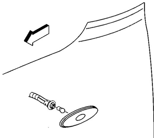
Rimuovere il pannello di rinforzo passaruota. Consultare [Sostituzione riempimento passaruota](#) : Parte Anteriore Veicolo.
