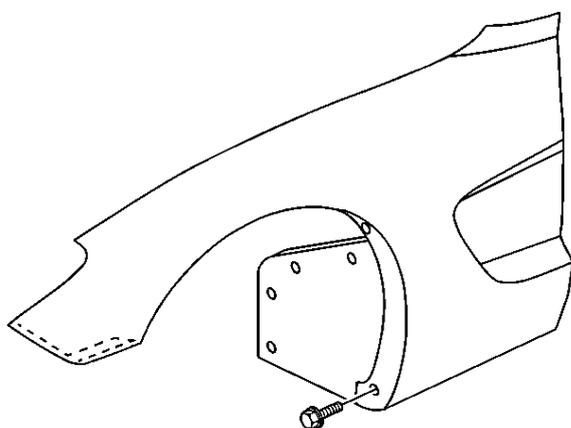
1. Rimuovere i bulloni che fissano il vano ruota del parafrangente al pannello di rinforzo.
