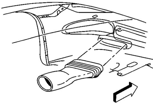
Posizionare il condotto di raffreddamento della pinza del freno sul fascione anteriore e premere il condotto verso il fascione per fissarlo.
