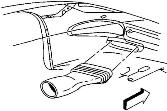
Posizionare il condotto di raffreddamento pinza freno sulla fascia anteriore e premere per fissarlo.
